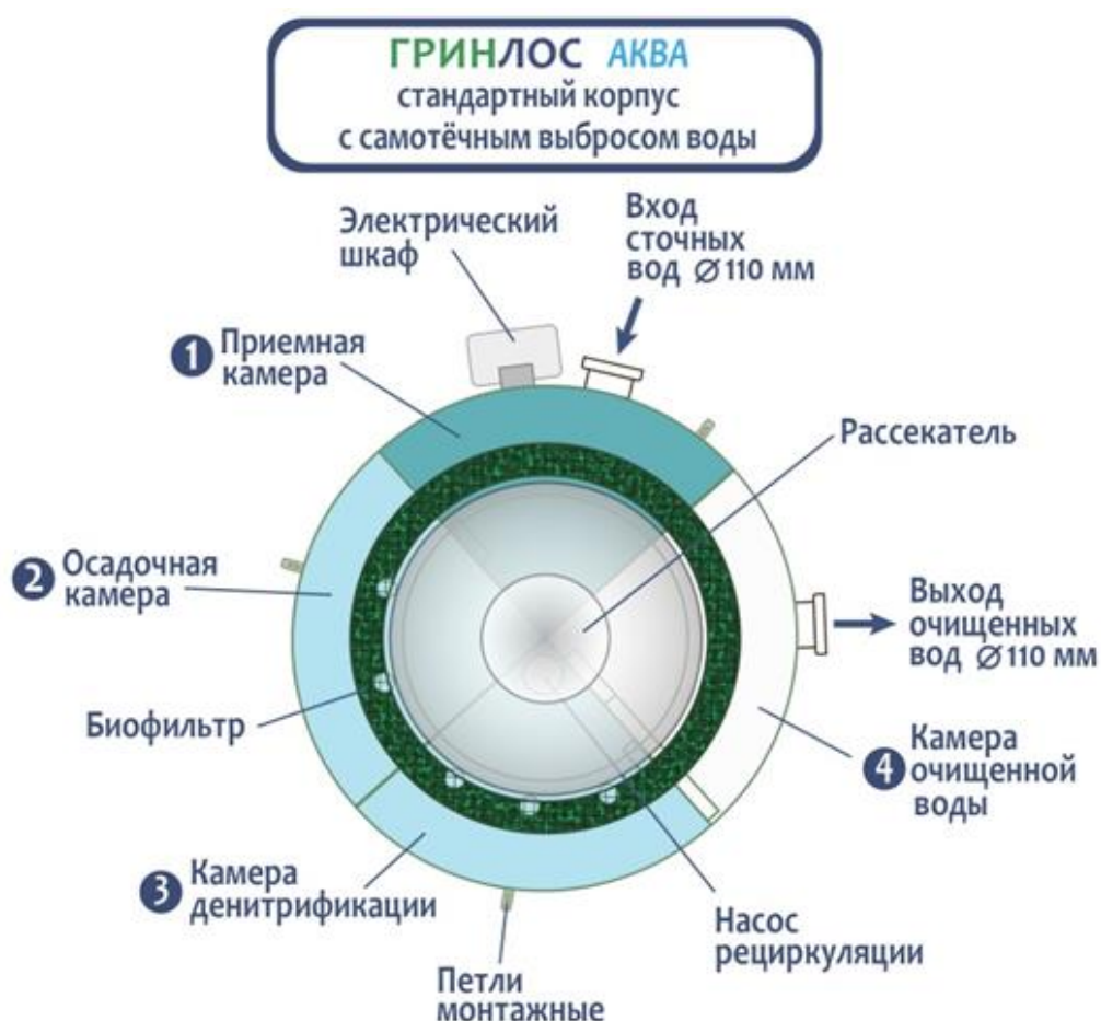
Рисунок 5. Технология очистки стоков в моделях со стандартным корпусом
