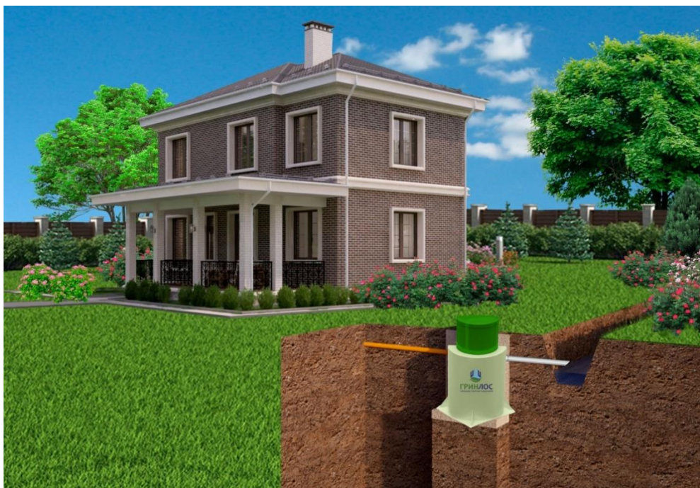
Рисунок 14. Монтаж с самотечным отводом очищенных сточных вод в дренажную канаву
