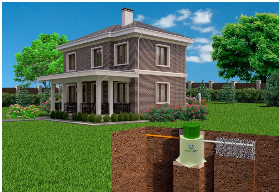
Рисунок 15. Монтаж с отводом очищенных сточных вод в дренажный элемент.
