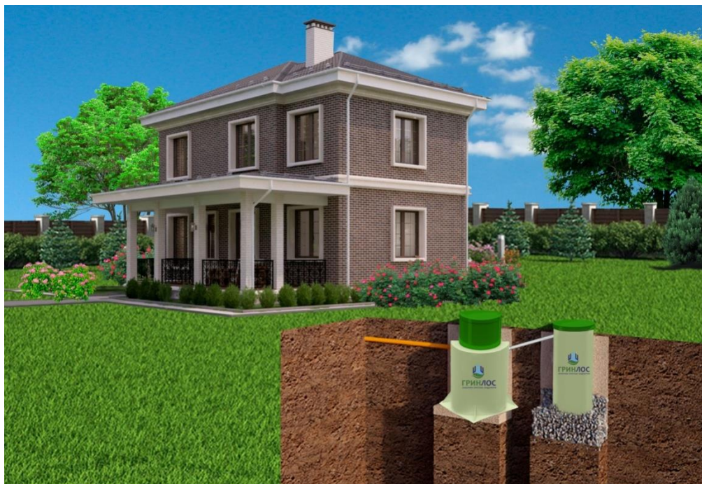
Рисунок 19. Монтаж с принудительным забором воды в фильтрующий колодец (Модели со стандартной высотой корпуса)
